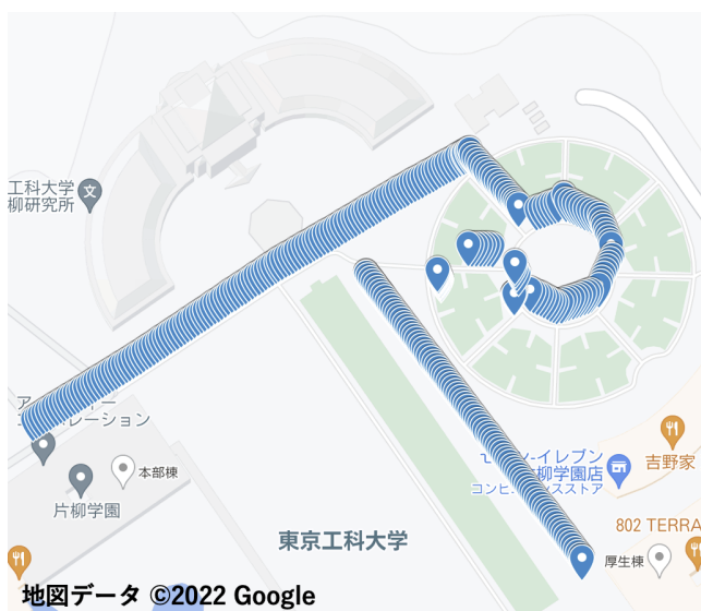
図 15 補正された自律航法の測位結果 東京工科大学構内 約 600 [m]
