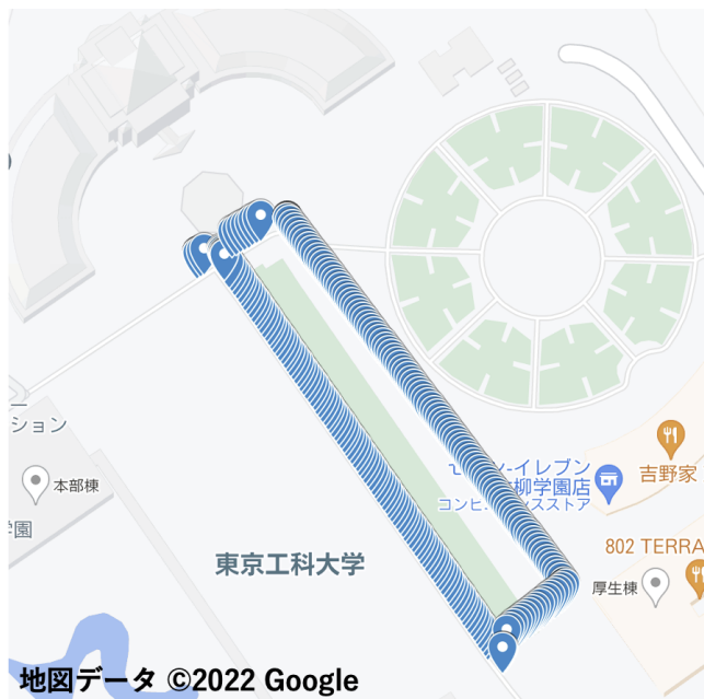
図 10 補正された自律航法の測位結果 東京工科大学構内 約 390 [m]
