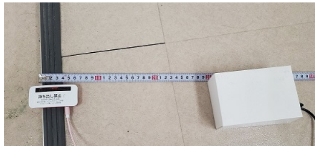
図 5 Raspberry Pi Zero が ESP32 の RSSI を取得する実験の様子
