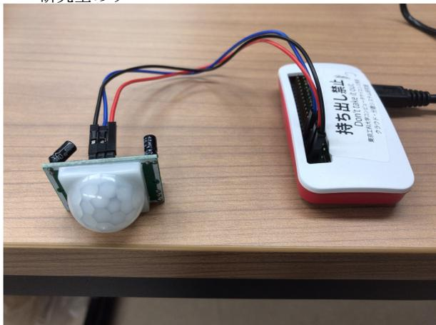
図 3:RaspberryPi zero と HC-SR501
