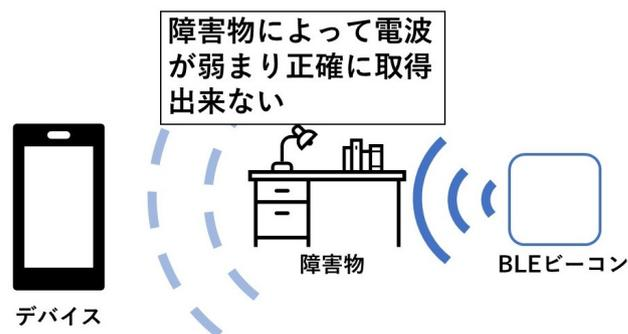
図 1 障害物により BLE ビーコンからの信号が弱まるイメージ図
