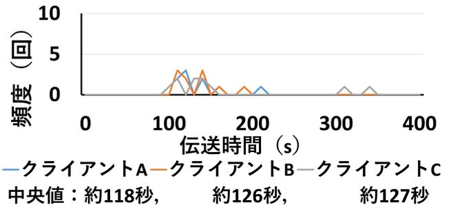
図 8 パケットを送信した後にマルチキャストのみで再送信した時の伝送時間
