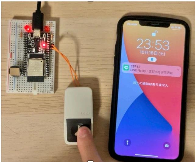
図 7 IoT 機器を使用した緊急通報システムの例
