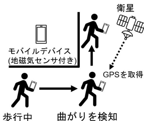
図4 地磁気センサによるGPS取得の判定
